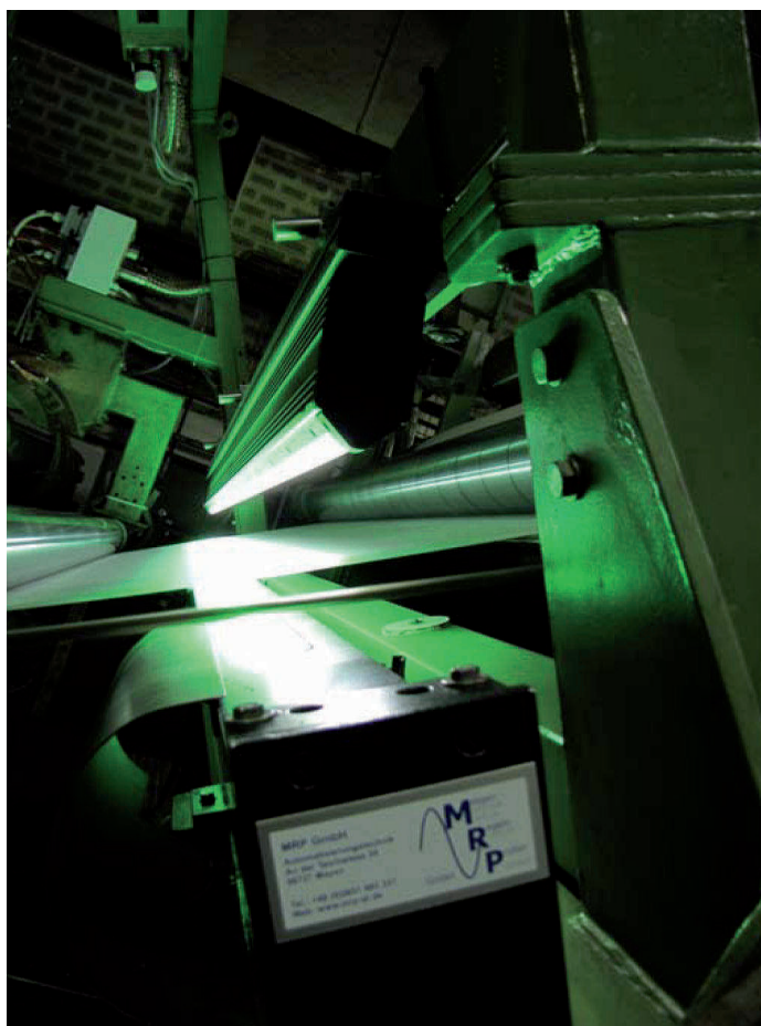
Die MRP Bahninspektion VIS 2008 kann Papierfehler exakt erkennen, lokalisieren und klassifizieren
